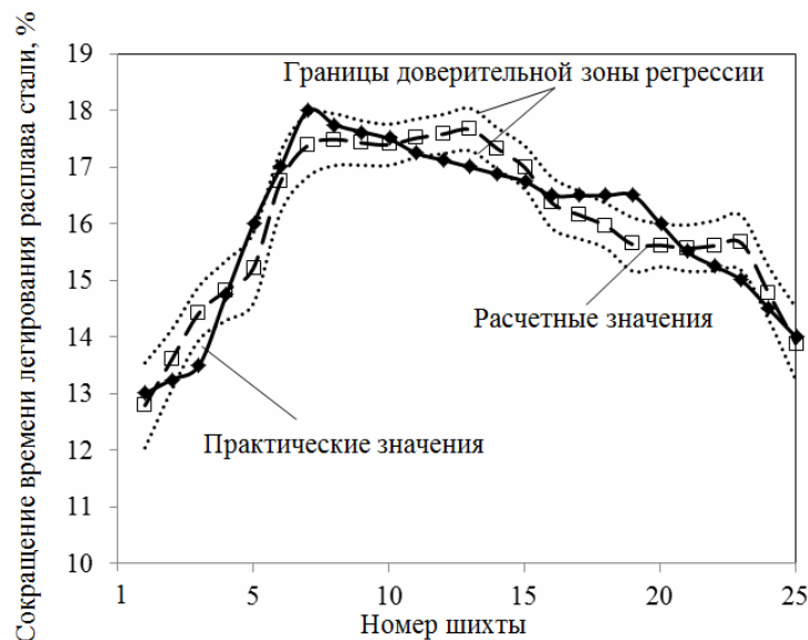
Рис. 1. Практические и расчетные значения сокращения времени легирования расплава стали с обозначением верхней и нижней границы 95 % доверительной зоны регрессии
