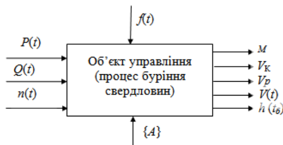
Рис. 1. Структурна схема процесу буріння свердловин як об'єкта управління [4]
