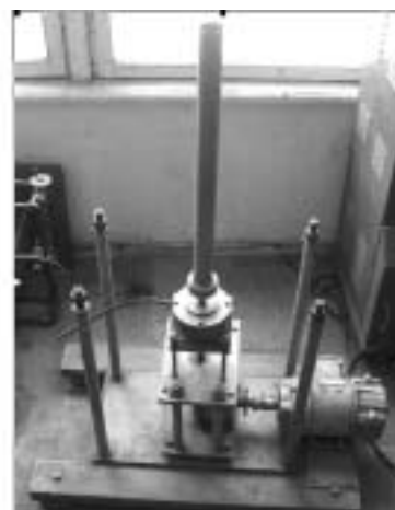
Рис. 1. Схема установки а и ее общий вид б : 1 – эксцентрик; 3 – эксцентриковый вибропривод; 5 – камера; 7 – цилиндр; 9 – пластина; 2 – корпус; 4 – мембрана; 6 – насадок; 8 – стержень; 10 – двигатель
