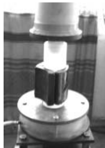
Рис. 3. Расположение постоянных магнитов на насадке гидропульсатора
