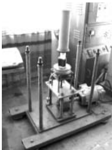
Рис. 2. Общий вид установки для одновременного воздействия гидрокавитации и омагничивания
