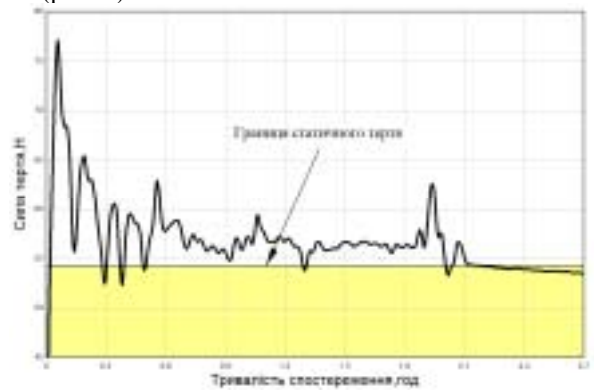
Рис. 6. Інтенсивність сил тертя для контактної пари при переході від зчеплення до проковзування. Сталь 30ХГСА-ШХ15, частота 50 Гц
