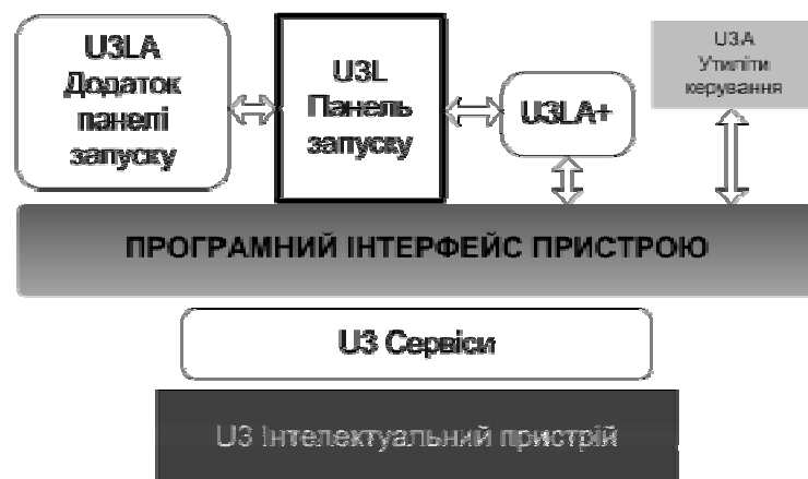
Рис. 1. Архітектура платформи U3 і система взаємодії між прикладними і системними програмами
