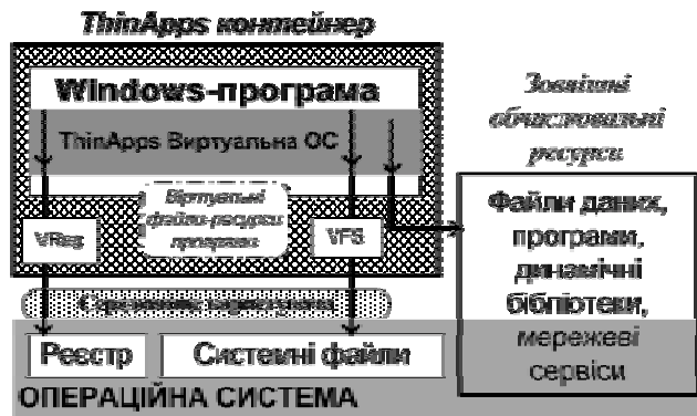
Рис. 4. Структурна схема взаємодії ThinApps-контейнера з операційною системою
