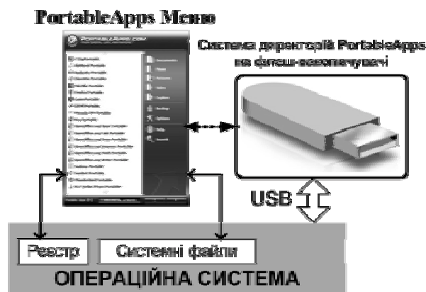
Рис. 2. Структурна схема роботи програми-оболонки PortableApps
