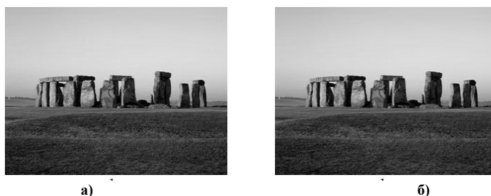
Рис. 6. Результат приховання інформації в JPEG зображення: а) пустий контейнер (розширення 800x600, розмір 123665 байт), б) заповнений контейнер (розширення 800x600, розмір 125015 байт, вбудовано 40196 біт)
