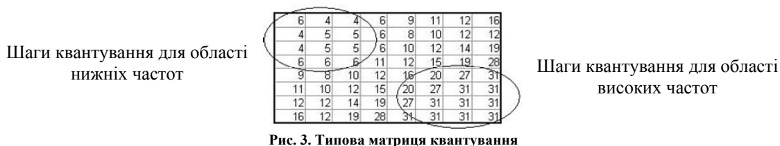
Рис. 3. Типова матриця квантування
