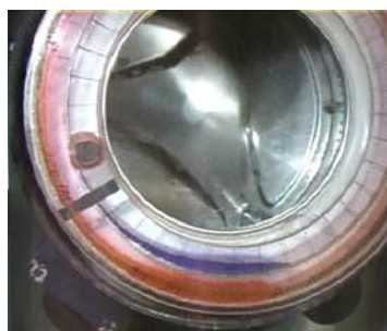
Рис. 5. Циркуляційний рух рідини в камері АБП
