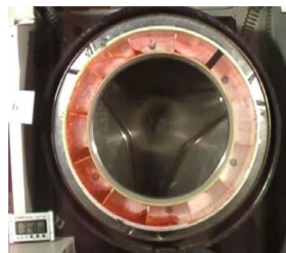
Рис. 13. Фрагмент відеозйомки захвату рідини камерою АБП з перегородками
