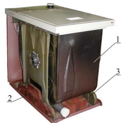
Рис. 1. Пральна машина "Айша": 1 – пральна машина "Айша"; 2 – вантаж масою 6 кг; 3 – вантаж масою 14 кг
