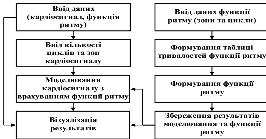
Рис. 8. Структурна схема блоку імітаційного моделювання циклічних сигналів
