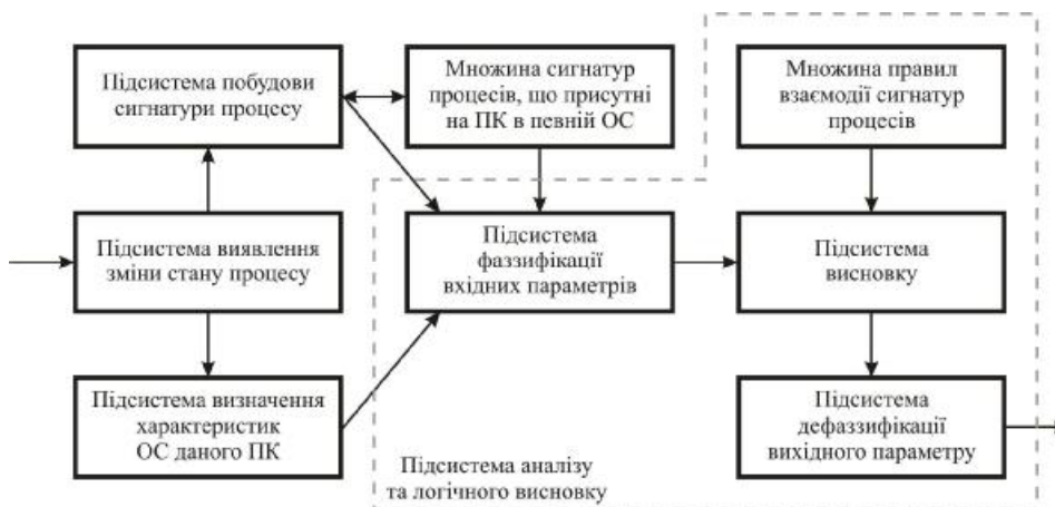
Рис. 1. Модель процесу прогнозування стану процесів в персональних комп'ютерах
