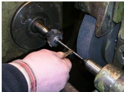
Рис. 8. Операція полірування вала ротора
