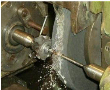
Рис. 7. Операція шліфування ротора турбокомпресора ТКР-7 Н1
