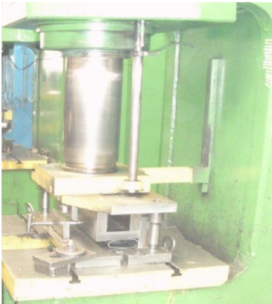
Рис. 1. Процес виготовлення труби в теплообмінник
