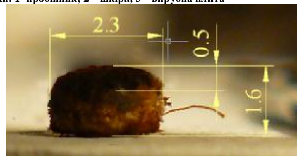
Рис. 3. Взаємодія пробійника, діаметром менше 5 мм, з висічкою, що знаходиться в його каналі. а – схематичне зображення; б – фотографія висічки: 1- пробійник; 2 – шкіра; 3 – вирубна плита
