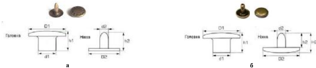
Рис. 18. Односторонні (а) та двосторонні (б) хольнітени, їх геометричні параметри
