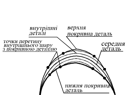
Рис. 4. Схема перерізу плечової накладки для двобічного жакета по окату
