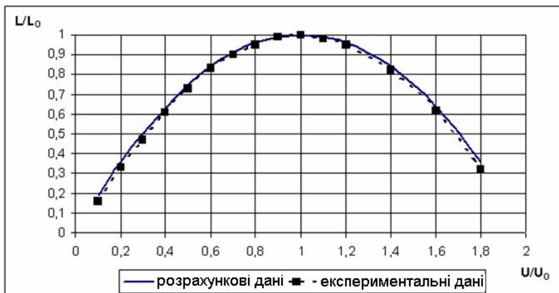
Рис. 3. Залежність приведення значення індуктивності від напруги керування
