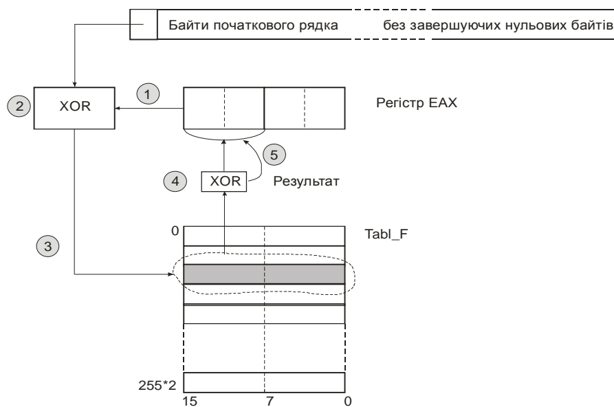
Рис. 4. Схема обчислень CRC з використанням прямого табличного алгоритму
