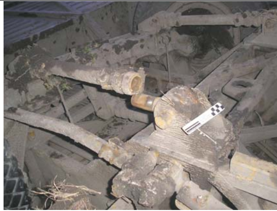
Рис. 3. Загальний вигляд пошкодження елементів передньої підвіски автобуса
