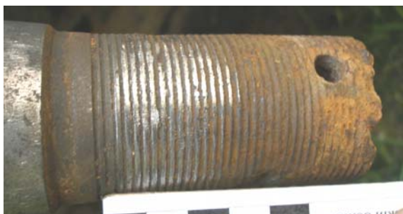
Рис. 6. Детальний вигляд пошкодження різьбової частини петлі причепа до автомобіля ЗІЛ-131 д.н.77-88 ХМП
