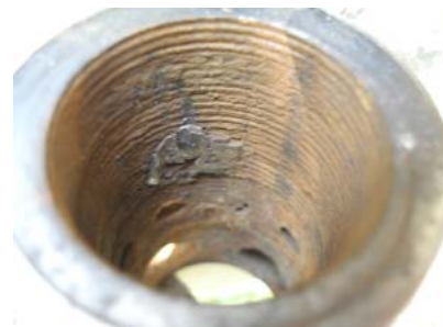
Рис. 6. Детальний вигляд пошкодження різьбової частини петлі причепа до автомобіля ЗІЛ-131 д.н.77-88 ХМП
