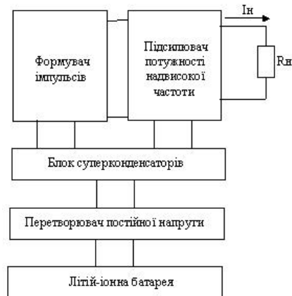
Рис. 3. Структурна схема генератора зондуючих імпульсів надширококутвих мобільних радіолокаторів із використанням блоку суперконденсаторів
