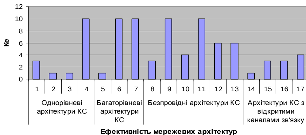
Рис. 1. Ефективність мережних архітектур за параметром емерджентності. Однорівневі: 1 – зіркова; 2 – моноканал; 3 – кільцева; 4 – систолічна. Багаторівневі: 5 – ієрархічна; 6 – зірково-магістральна; 7 – мереживо-ієрархічна; безпроводні: 8 – з пасивним ретранслятором; 9 – безретрансляційні; 10 – з активним ретранслятором; 11 – зірково-магістральна; 12 – з активним ретранслятором та кільцевою структурою; 13 – сотова. З відкритими оптичними каналами зв'язку: 14 – високошвидкісна дуплексна; 15 – середньошвидкісна кільцева; 16 – низькошвидкісна кільцева; 17 – розгалужена
