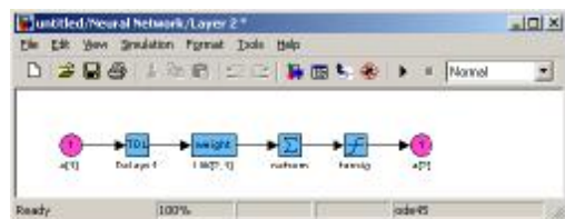
Рис. 7. Структурна схема другого шару ШНМ
