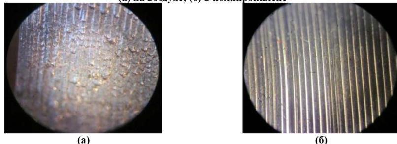
Рис. 6. Поверхность, полученная после точения ( $n=1250$  об/мин,  $S=0.2$  мм/об,  $t=0.5$  мм, увеличение 50) (а) на воздухе; (б) в полипропилене
