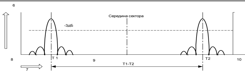
Рис. 2. Принцип визначення кутових координат ПС в системі посадки сантиметрового діапазону: 1- азимутальна антена; 2 – осьова лінія ЗПС; 3- сканування « туди »; 4- сканування « назад »; 5 – сигнальні імпульси; 6- поріг вимірювання -3дБ; 7- час, мс; 8- початок сканування « туди »; 9- кутове положення ПС пропорційне результату вимірювання часової різниці T_1 - T_2 ; 10 – кінець сканування « назад »
