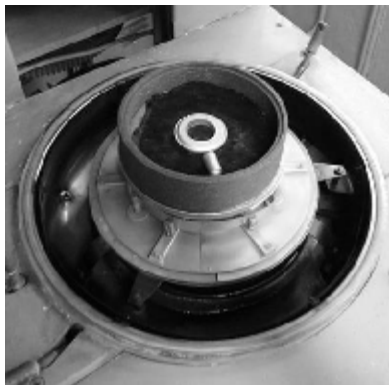
Рис. 6. Розташування ролика у графітовому контейнері
