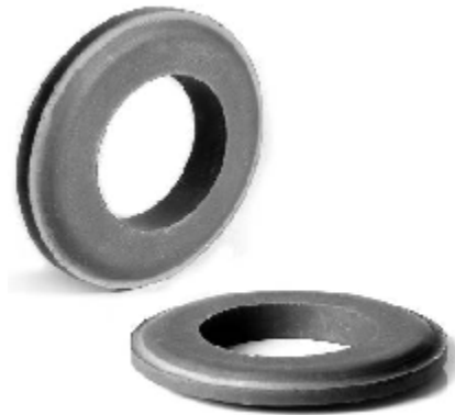
Рис. 7. Вигляд твердосплавних роликів для ЕМО після спікання
