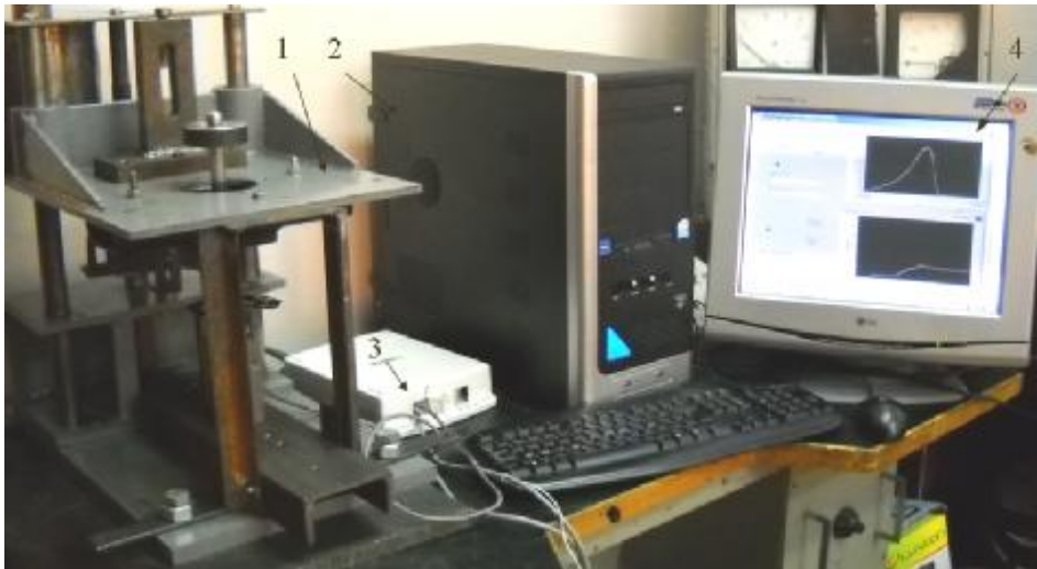
Рис.2. Експериментальний стенд для дослідження технологічної операції вирубання отворів під металеву фурнітуру у матеріалах: 1 – експериментальна установка; 2 – ЕОМ з вмонтованим АЦП; 3 – блок узгодження сигналів; 4 – інтерфейс програмного забезпечення LabVIEW
