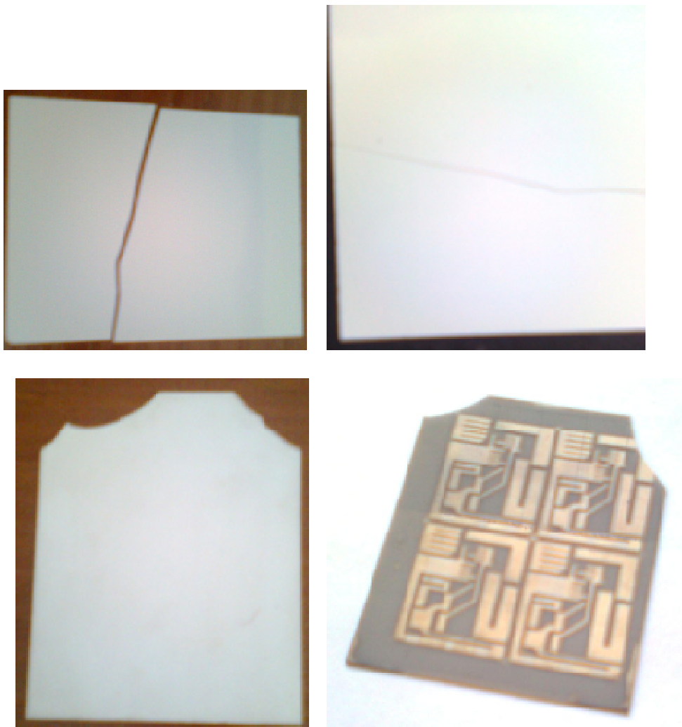
Рис. 3. Фотокартки типових скритих дефектів (тріщини – верхній ряд, руйнування кутів – нижній ряд) підкладок мікробірок
