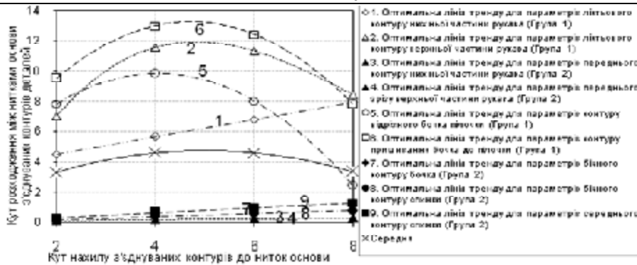
Рис. 2. Узагальнений графік оптимальних ліній тренду залежностей кута розходження між нитками основи контурів з'єднаних деталей від кута їх нахилу до ниток основи
