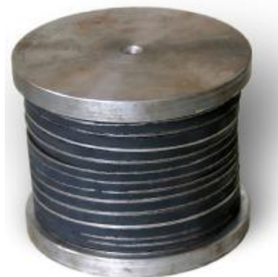
Рис. 3. Загальний вигляд камери приладу для визначення параметрів пружності дискретних матеріалів
