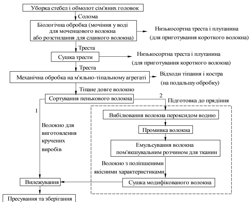
Рис. 1. Технологічна схема отримання довгого тіпаного пенькового волокна: 1 – існуюча; 2 – запропонована додаткова обробка.
