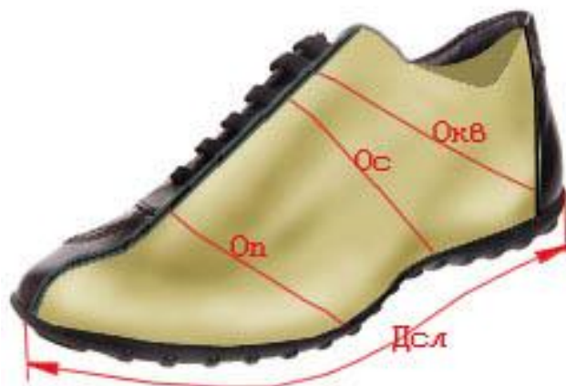
Рис. 2. Відновлення внутрішньої форми взуття та дослідження її параметрів
