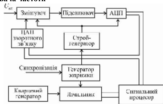
Рис. 1. Структурна схема цифрового стробоскопічного перетворювача частоти
