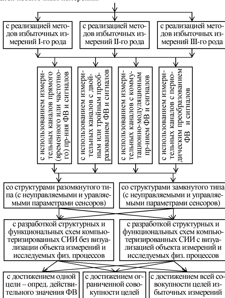
Рис. 2. Продолжение классификации путей и методов решения измерительных задач
