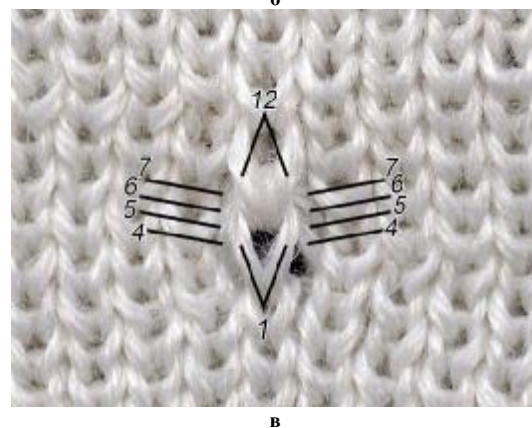
Рис. 1. Графічна схема (а) та зразки обох боків (б, в) комплексу пресової петлі високого індексу подвійного трикотажу
