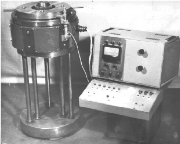
Рис. 9. Загальний вигляд доводочної вібраційної машини ВДМ-400-2А
