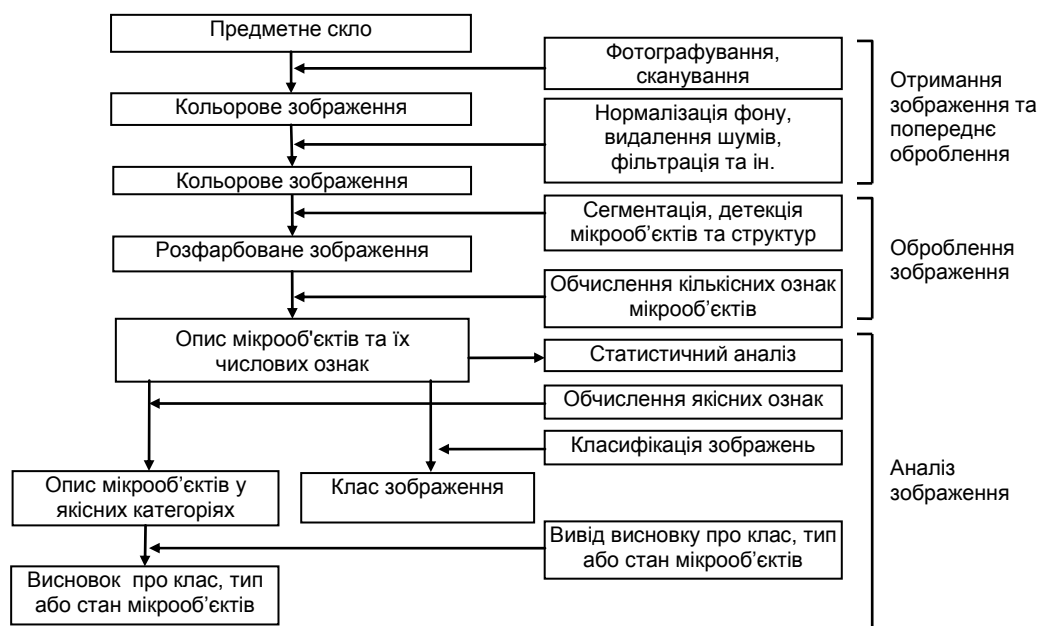
Рис. 2. Діаграма технології опрацювання гістологічного зображення
