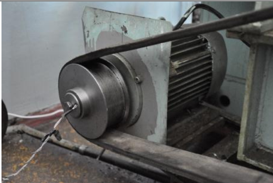
Рис. 1. Модернізований привід основов'язальної машини Кокетт – 2 (фрагмент)
