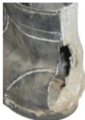
Рис. 4. Руйнування матеріалів верху в місцях зшивання деталей
