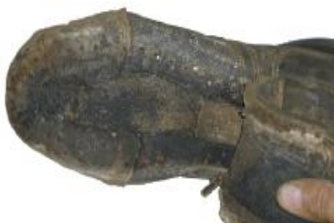
Рис. 3. Руйнування конструкції в місці з'єднання верху до низу
