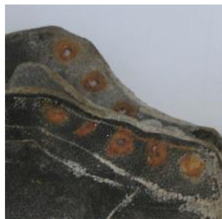
Рис. 6. Корозія металічних деталей взуття
