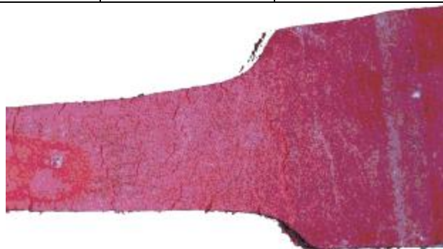
Рис. 7. Лицева поверхня нубуку після напівциклового розтягу (тріщини лицевій поверхні)
