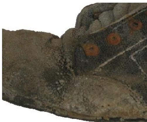
Рис. 5. Руйнування матеріалу в місцях багаторазового згину
