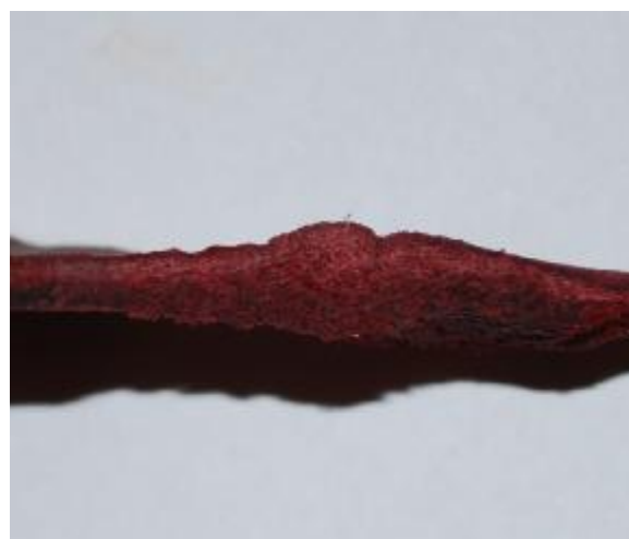
Рис. 8. Стовщення шкіри ХМД після напівциклового розтягу та попередньої дії насиченого розчину хлориду натрію. Вид збоку
