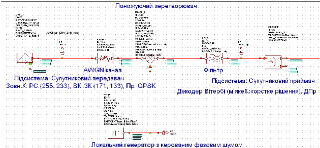
Рис. 16. Імітаційна модель супутникового каналу передавання інформації: Зовн. к – зовнішній код; РС – код Ріда – Соломона; ВК – внутрішній код; ЗК – згортковий код; Пр – перемежувач; ДПр – деперемежувач
