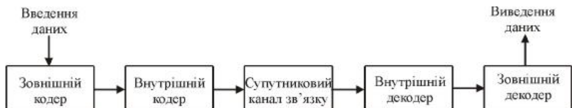
Рис. 4. Узагальнена схема супутникового каналу зв'язку з використанням дворівневого способу каскадного кодування
