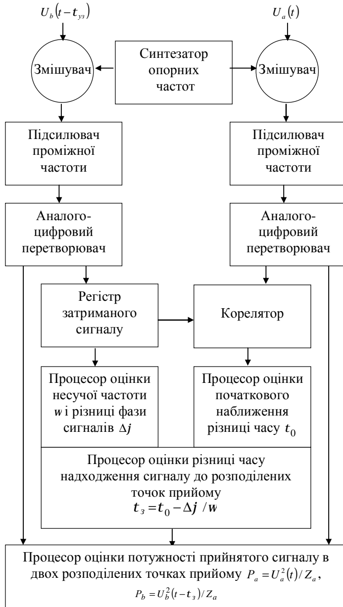
Рис. 1. Структурна схема вимірювання різниці часу і потужності прийнятого сигналу в розподілених точках прийому
