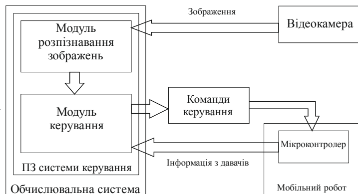
Рис. 2. Структура системи керування мобільним роботом
