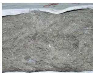
Рис. 3. Види наповнювачів для килимків: а) конопля, б) льон (поперечні перерізи)
