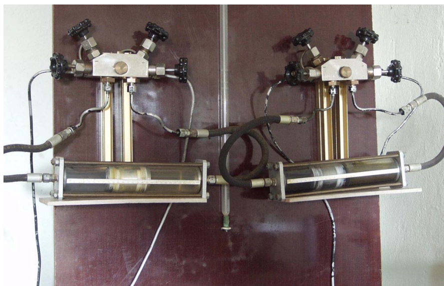
Рис. 10. Загальний вигляд системи вимірювання бокових деформацій
