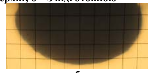
Рис. 8. Зразки з застосуванням флюсу ортофосфорна кислота: а – без підготовки поверхні; б – з підготовкою
