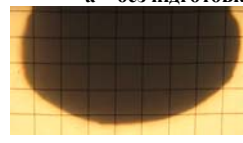
Рис. 8. Зразки з застосуванням флюсу ортофосфорна кислота: а – без підготовки поверхні; б – з підготовкою
