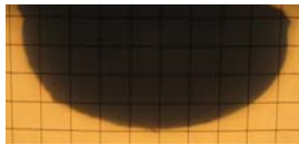
Рис. 3. Зразки з застосуванням флюсу F6 а – без підготовки поверхні; б – з підготовкою
