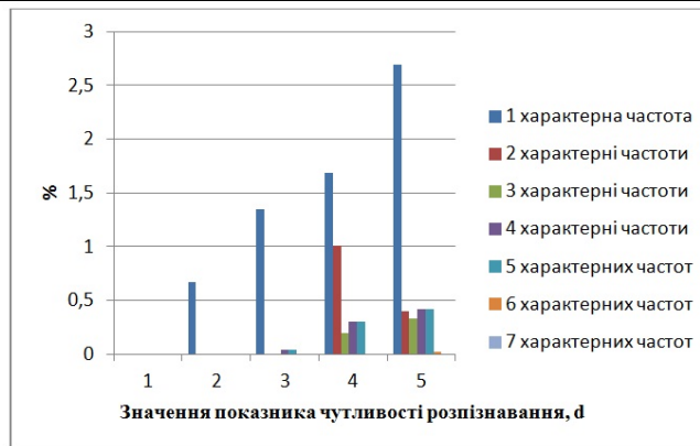
Рис. 5. Ймовірність співпадання всіх характерних частот трьох електродвигунів
