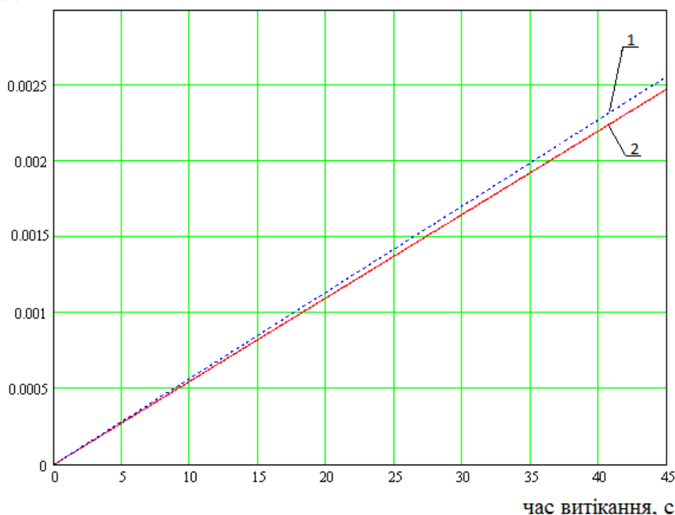
Рис. 2. Залежність динамічної в'язкості \eta від часу витікання \tau : 1 – експериментальна залежність; 2 – теоретична залежність
