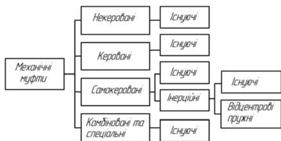
Рис. 3. Уточнена класифікація механічних муфт
