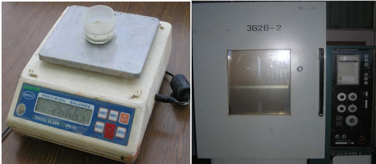
Рис. 3. Ваги і термобарокамера, що використовуються при проведенні випробувань для визначення вологовмісту пилу у ВСЦ НВП ХАРТРОН-АРКОС
