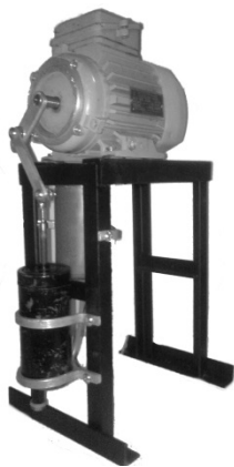
Рис. 3. Фото пристрою для розпилення рідини
