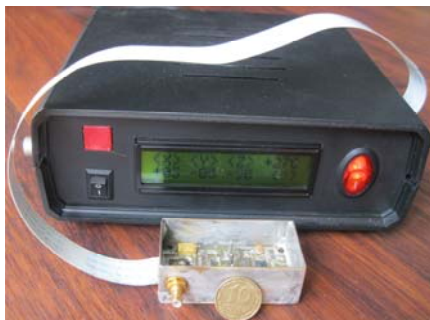
Рис. 5. Вимірювач просторового положення BQ1 – просторово-орієнтований внутрішній кварцовий резонатор; BQ2 – просторово-орієнтований зовнішній кварцовий резонатор
