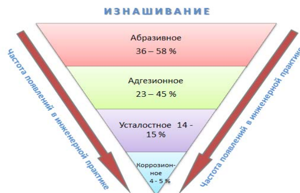
Рис. 2. Частота появления видов изнашивания при взаимодействии стальных поверхностей
